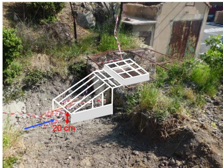
Figure 37 : Exemple d'aménagement de l'ouvrage
